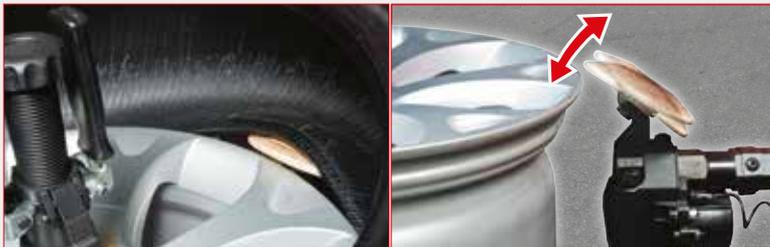
**Procedura rapida** smontaggio secondo tallone resa possibile da **movimento disco brevettato**, particolarmente indicata per pneumatici a fianchi duri.
